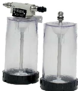
Фильтры объемные Ф0-500 (Pa2.966.015-06ПС), Ф0-0-500 (Pa2.966.015-15) предназначены для удаления крупнодисперсной пыли (Ф0-500) и понижения влагосодержания (Ф0-0-500) газовой смеси, подаваемой на вход газоанализатора.
