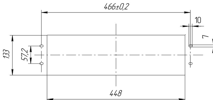
Рисунок 2.1 – Разметка щита для установки распределителей
