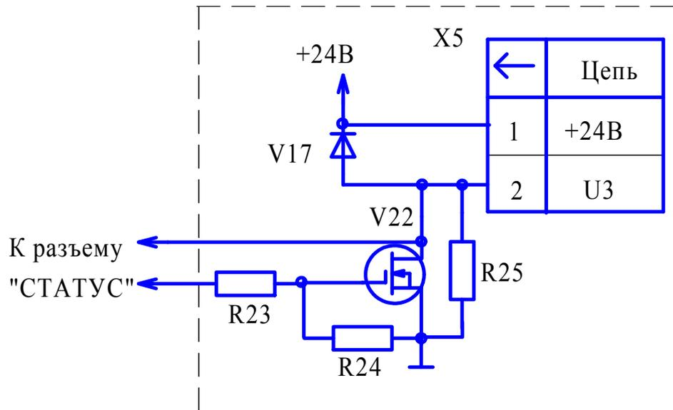
Рисунок 1.2 - Схема электрическая принципиальная формирователя сигнала СТАТУС
