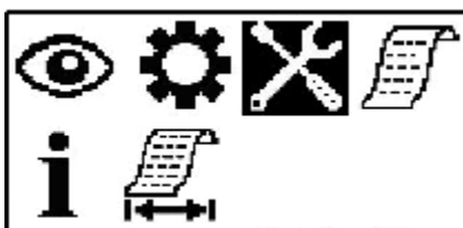
Рисунок 2.7 – Меню выбора специальных режимов (инверсией выделен выбранный символ)
